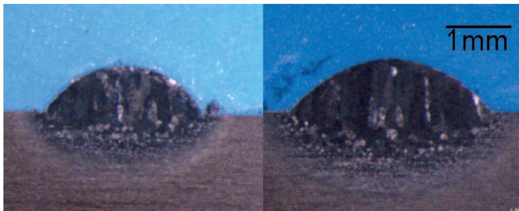
Figura 2. Corte transversal de los cordones 1 y 11 que se han seleccionado.
