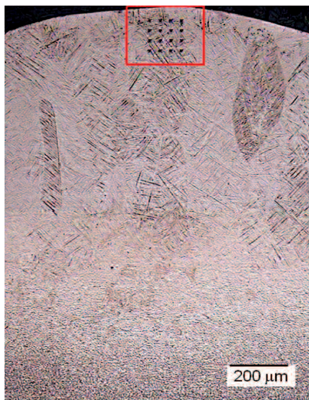
Figura 3. Microestructura del cordón 1 y posición de la matriz de nanoindentación.
