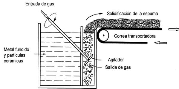
**Figura 2.** Producción de EM por inyección de gas<sup>[34]</sup>.
