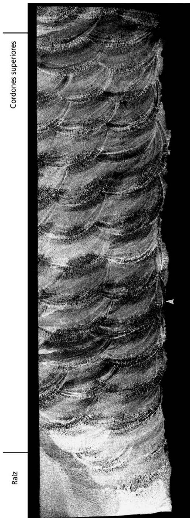
**Figura 16.** Macrografía òptica de la secci3n transversal de la probeta tomada por la iniciaci3n de la fractura
