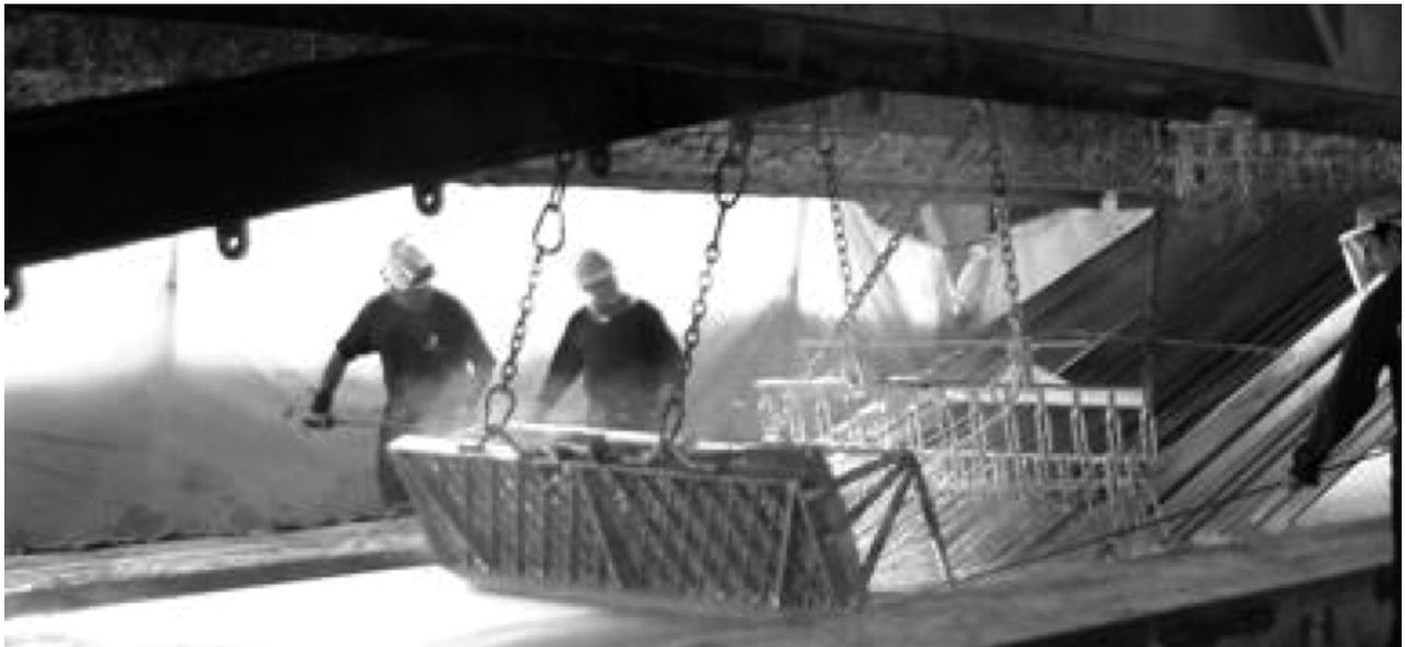
**Figura 8.** Proceso de galvanizado en caliente para grandes perfiles estructurales.
