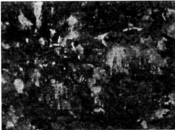
Figura 6. Microestructura perlítica presente en el centro de la zona de empuñadura del hacha (x 375).
