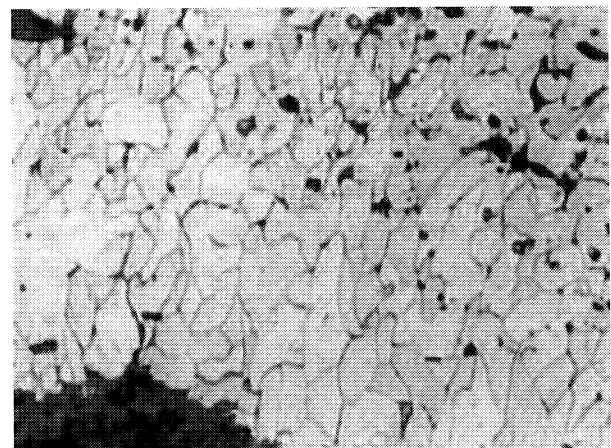
Figura 10. Microestructura ferrítica deformada presente en la zona de filo del hacha (x 375).
