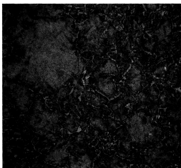
FIG. 3.— Microestructura del acero 2A después del tratamiento de normalizado (x200).
