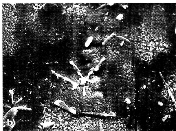
FIG. 6.— Morfología de la capa de inhibición frente a la velocidad de enfriamiento ( $v_e$ ) para las muestras: a) A ( $v_e = 5\text{ °C seg}^{-1}$ .  $\times 2.500$ ), y b) D ( $v_e = 22\text{ °C seg}^{-1}$ .  $\times 2.500$ ).
