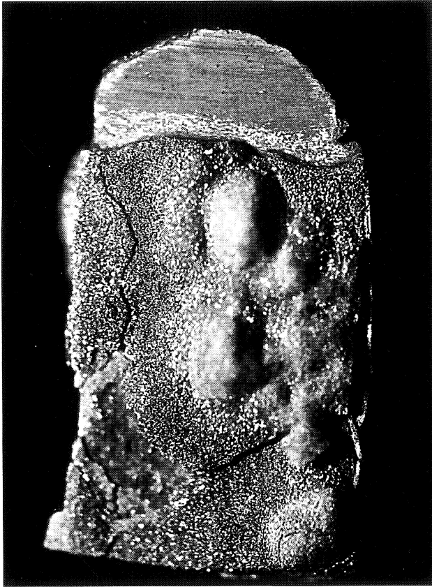
FIG. 9.— Micrografía de la fase \alpha del cromo crecida a partir del intermetálico original.
